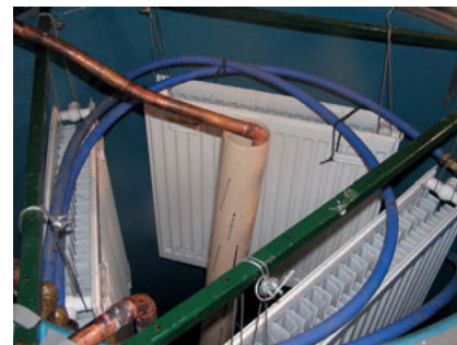
Figure 9.31 L'échangeur, constitué de trois radiateurs.
