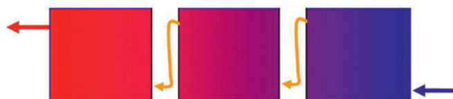
Figure 3.6 Raccordement des capteurs en série : le réchauffement de l'eau n'est plus optimisé au-delà de deux capteurs.
