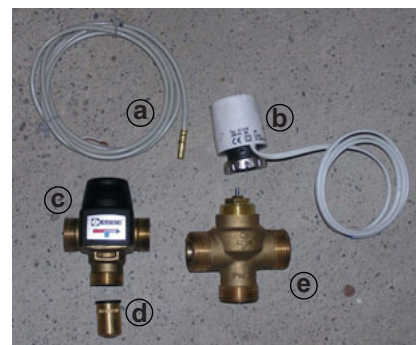
Figure 9.36 Vannes et sonde PT1000 utilisées. (a) Sonde PT1000. (b) « Moteur » de la vanne 3 voies. (c) Vanne thermostatique. (d) Antiretour. (e) Vanne 3 voies (à siège).
