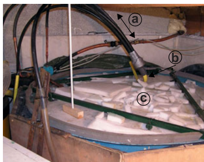
Figure 9.34 La surface du stock. (a) Mises à l'air. (b) La sortie des mises à l'air est au-dessus de la surface libre. (c) Pavés de mousse découpés et déposés à la surface de l'eau pour 1 re isolation.
