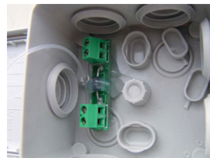
Figure 5.8 Diode de protection antifoudre. La diode, recouverte de colle, est connectée en amont et en aval (par les deux parties vertes) aux capteurs et à la centrale. En cas de surtension, la diode crée un court-circuit.
