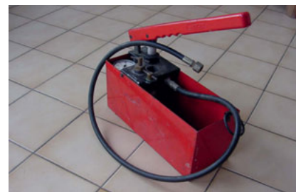
Figure 8.14 Cette pompe, équipée de son bac de dépôt pour l'antigel, permet de monter en pression jusqu'à 45 bars, ce qui permet de faire des tests d'étanchéité. Dans notre cas, 4 bars suffisent pour éprouver la sécurité des soupapes avant le remplissage définitif.
