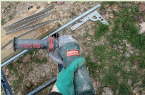
Coupe au lapidaire d'une tige filetée.
