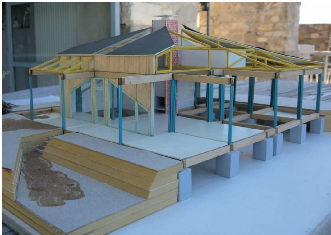
Maquette de la maison proposée par le cabinet de Gérard François au SAD. Au centre, la cheminée contrevente la structure, qui s'appuie donc sur elle : cette disposition, qui met la source de chaleur au centre, est, d'un point de vue physique, d'une justesse extrême. Par ailleurs, la structure avait aussi été pensée pour recevoir des panneaux solaires. Les poteaux verticaux sont métalliques : refusant de se dissimuler, ils participent de l'élégance du prototype.
