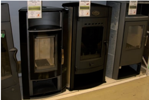
Trois modèles de poêles vendus en grande surface, idéaux à insérer dans une masse : ils acceptent les bûches de 50 cm (moins de recoupes de bois); une lame d'air empêche la vitre de se noircir, et une arrivée d'air secondaire permet une combustion complète, donc un meilleur rendement. Coût : autour de 2 000 €.
