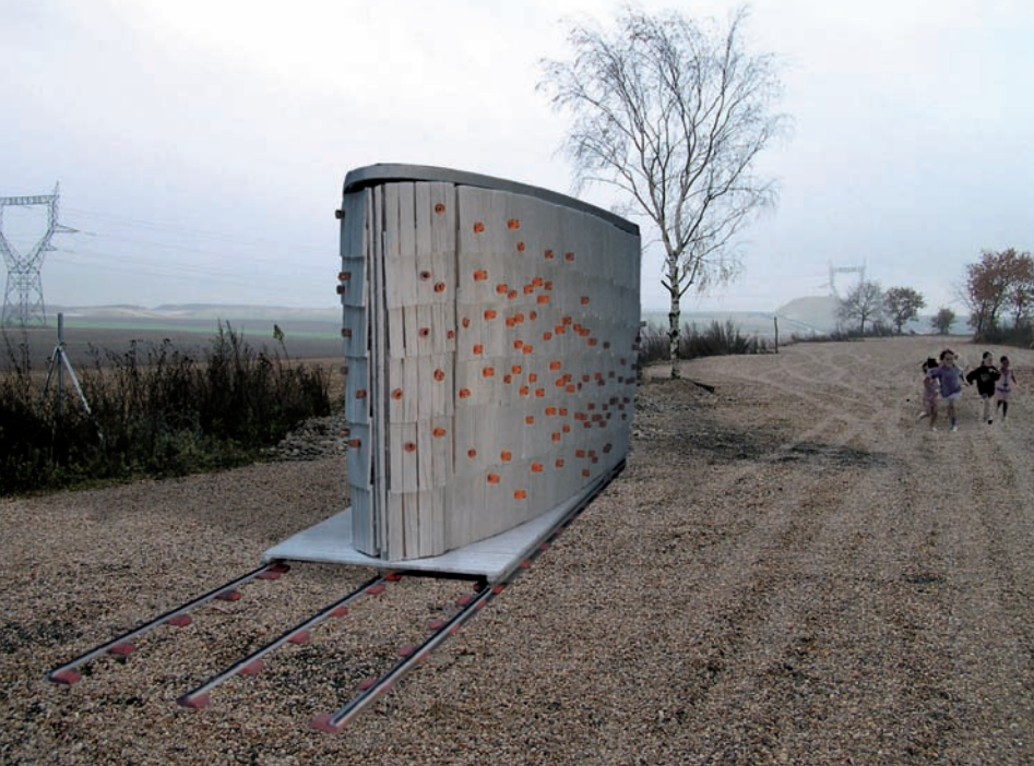
L'habitat refermé : remarquez les rails qui permettent le déplacement de la partie mobile. (L'ensemble des images de cette page a été réalisé par Peggy Garcia, Caroline Mangin, Jean-Baptiste Bureaux, architectes DPLG, et Céline Oriol, urbaniste.)
