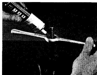
Versez de l'huile légère sur les filets, durant le filetage. Faites marche arrière à chaque demi-tour pour retirer la limaille.
