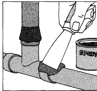
Une pâte d'époxy arrête les fuites des raccords. Coupez l'eau.
