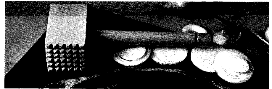
Les dents sont découpées à la lime triangulaire et poncées.
