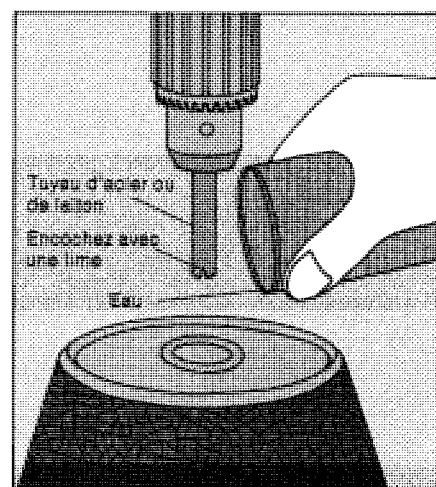
Ajoutez un peu d'eau. Le diamètre extérieur du tuyau doit être égal à la dimension du trou.
