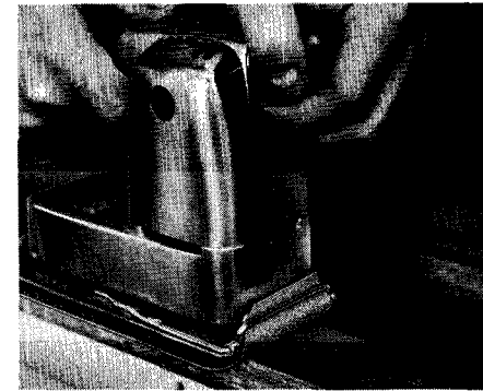
L'usage d'une ponceuse-finisseuse après celui de la ponceuse à courroie hâte le travail sur les grandes surfaces plates.
