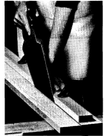
Pour refendre en ligne droite, coupez en suivant un tasseau fixé à la serre.
