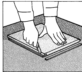
Coupez au couteau les languettes sur les bords du carreau de remplacement.
