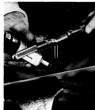
Versez de l'huile sur le taraud pour faciliter le taraudage. Dévissez après 2 ou 3 tours pour retirer la limaille.
